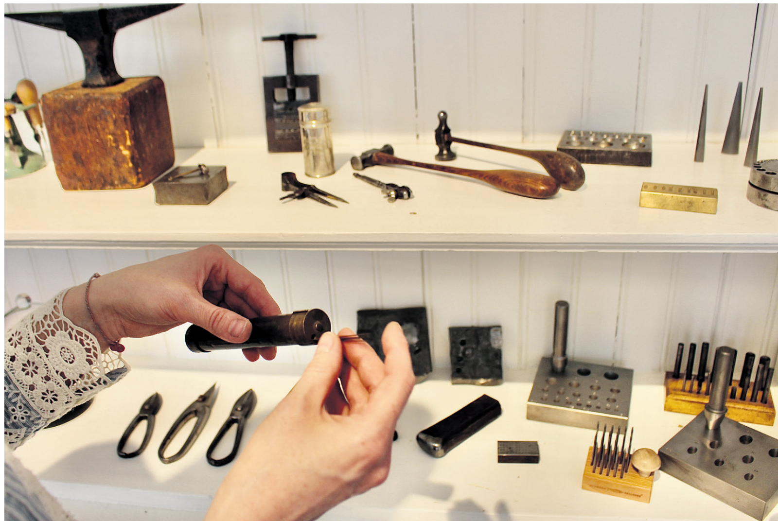
På hylderne står der gamle værktøjer, der allesammen er i brug - ambolt og hammer, passer, punslere, stempler, udhugger, pladesakse, skydelære og fatningsjern.
